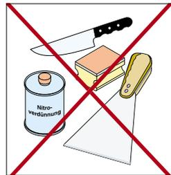
**1.2 Für PVC-Hart mit folienkaschierter Oberfläche** Ihre Fenster sind mit hochwertigen, gütegesicherten PVC-Folien kaschiert, die ein Optimum an UV-Stabilität gewährleisten. Zum Schutz dieser Folien vor Witterungs- und Alterungseinflüssen ist eine zweite, farblose Acrylat-Deckfolie dauerhaft aufgetragen. Anlösende oder scheuernde Reinigungsmittel zerstören diese Schutzschicht! Folienkaschierte Profile pflegt man am besten mit dem Schüco EasyCare
